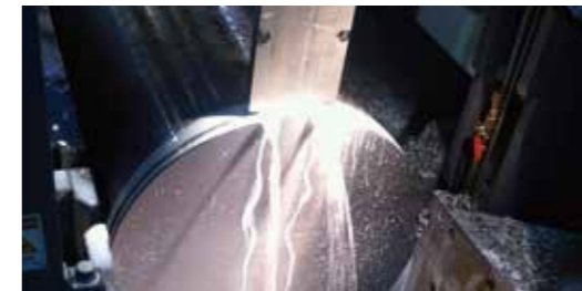
強力切削液依據料寬自動調整至最佳給水位置，讓冷卻效果更佳(專利)。
