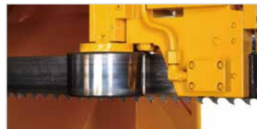
大型防震滾輪，大幅降低震動與噪音產生。
