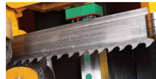
合濟新式鎢鋼鋸帶，具有更快速的鋸切性能。
