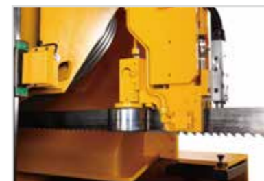
左同動導臂採用線性滑軌移動。
